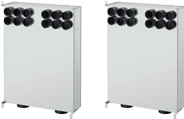
Kompakt egység a befűjt és elszívott levegő csatlakoztatására NÁ 125 és 2x 7 db egyedi csatlakozócsonk NÁ 75, a befűjt levegővel a jobb, ill. bal oldalon.
